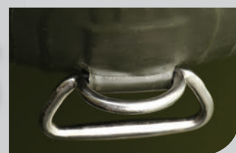
Кольцо для буксировки/постановки на якорь из нержавеющей стали
